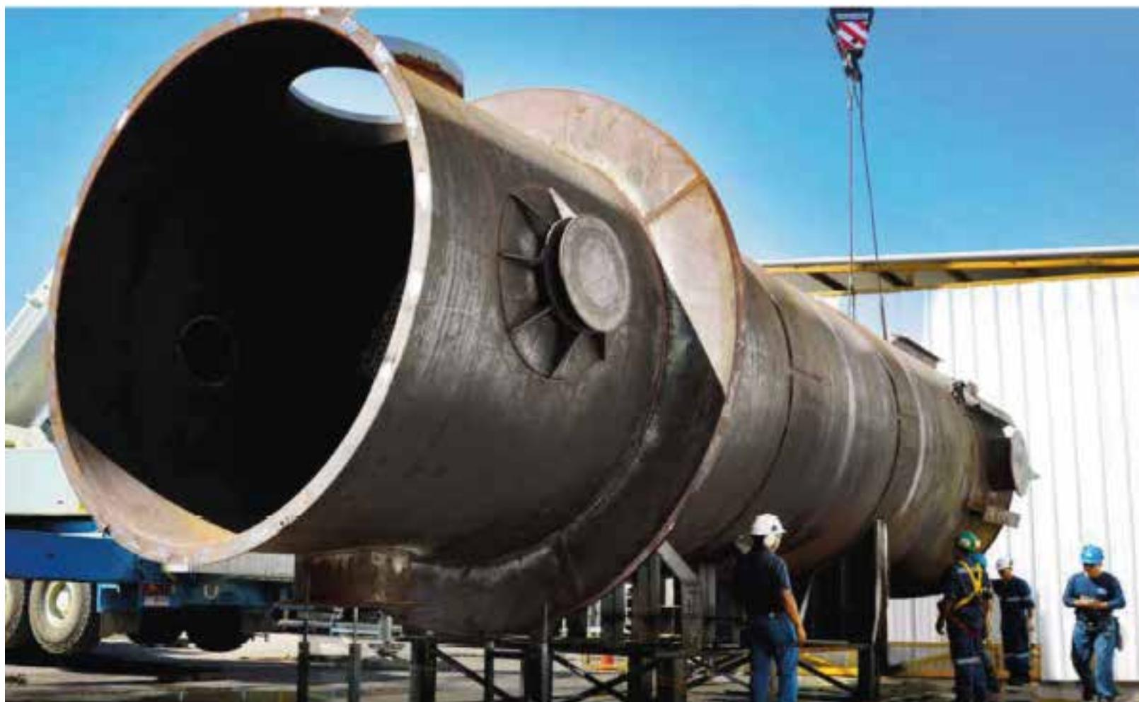
Fabricación de intercambidores 1PM e IC2 para planta de Ácido, Fundición Paipote
